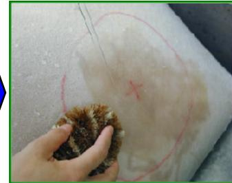
実験終了。カーペットが一部変色。(写真は長毛カーペットの例)
