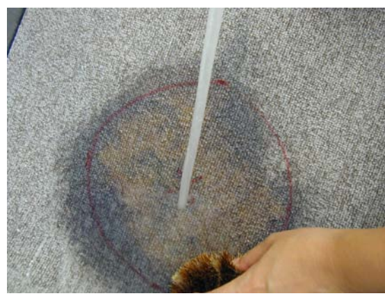
写真6 実験後のカーペット（ゴム裏張り）
