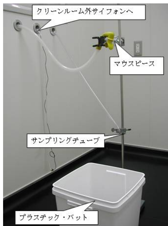
写真1 クリーンルーム内での模擬おう吐物の落下による飛沫粒子発生実験
